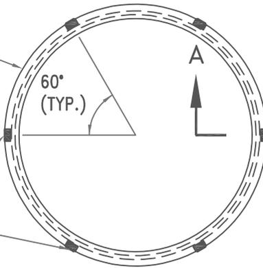
ALIGN PLATES TO FACE IN DIRECTION OF UPSTREAM WASH FACE
